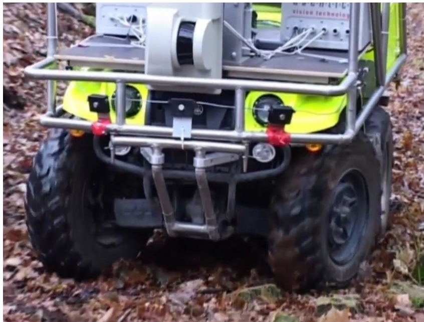
Abbildung 3.6: Anspruchsvolle Bodenverhältnisse erzeugen Radschlupf bei einer autonomen Testfahrt des Roboters AMOR.
