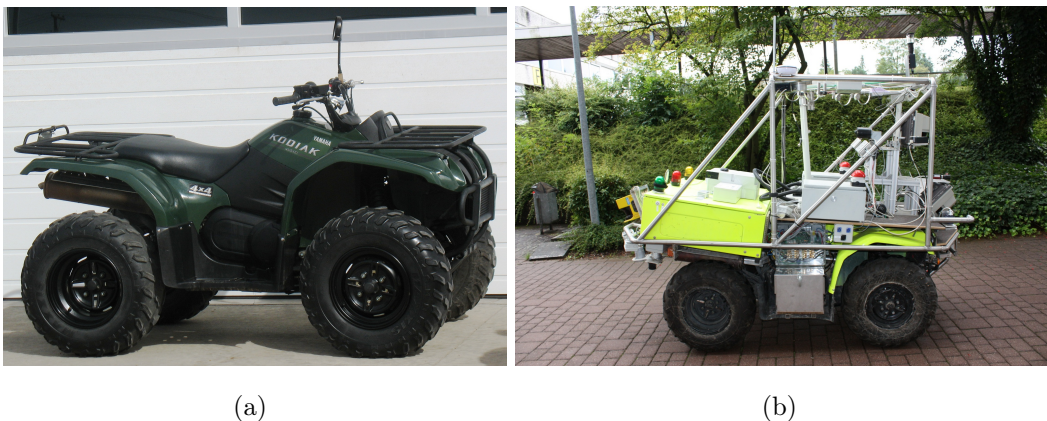
Abbildung 2.3: Bodenroboter AMOR vor (a) und nach (b) Umbau der mechanischen Plattform.
