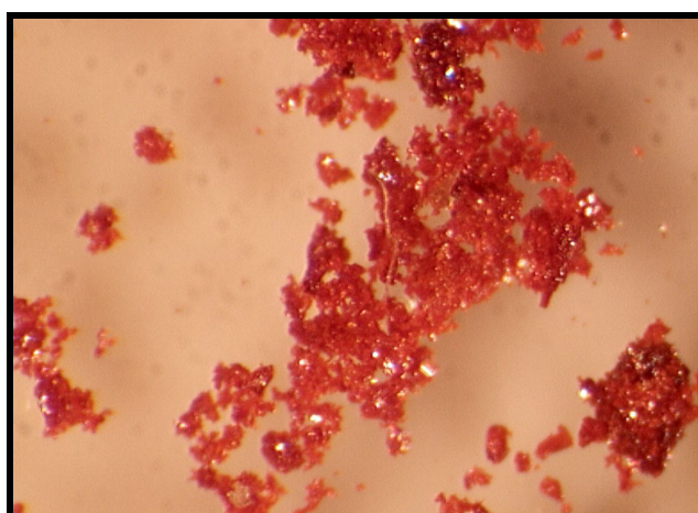
Abbildung 4.2: Lichtmikroskopische Aufnahme verwachsener RbIn_3S_5 -Kristalle.
