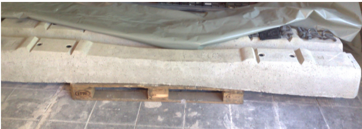
Abb. 5.1: Prüfobjekt der ersten Beispielapplikation, Bahnschwelle aus Spannbeton
