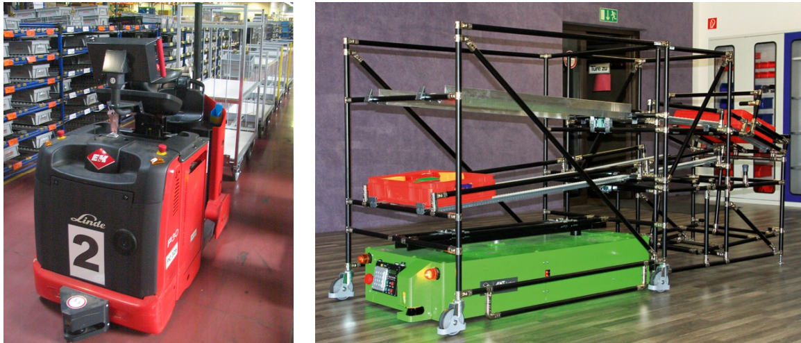
Abb. 10: Fahrerloser Schlepper zum Ziehen mehrerer Anhänger (links) und Unterfahrschlepper zum Transport von KLT in Regalen (rechts) [E&K Automation; ANT-System]
