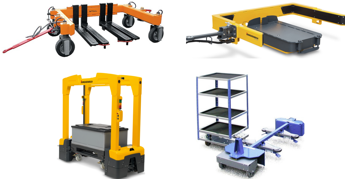
Abb. 13: Anhänger mit C- und E-Rahmen zur einseitigen Be- und Entladung (oben) sowie U- und H-Rahmen zur beidseitigen Be- und Entladung (unten) [STILL; Jungheinrich; BeeWaTec]
