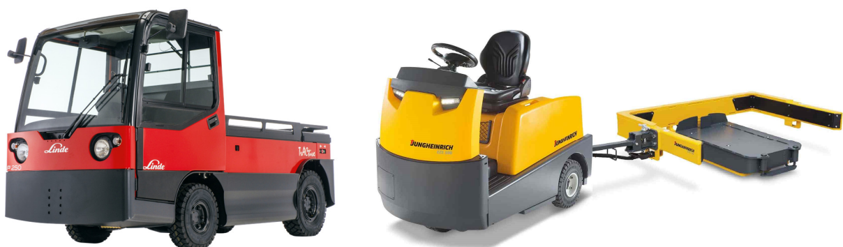
Abb. 5: Plattformwagen (links) und Schlepper mit Anhänger (rechts) [Linde; Jungheinrich]
