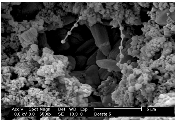
Abbildung 13: Befall durch Mikroorganismen in perlenschnur-artiger Form im Mörtel D5 aus Dorste
