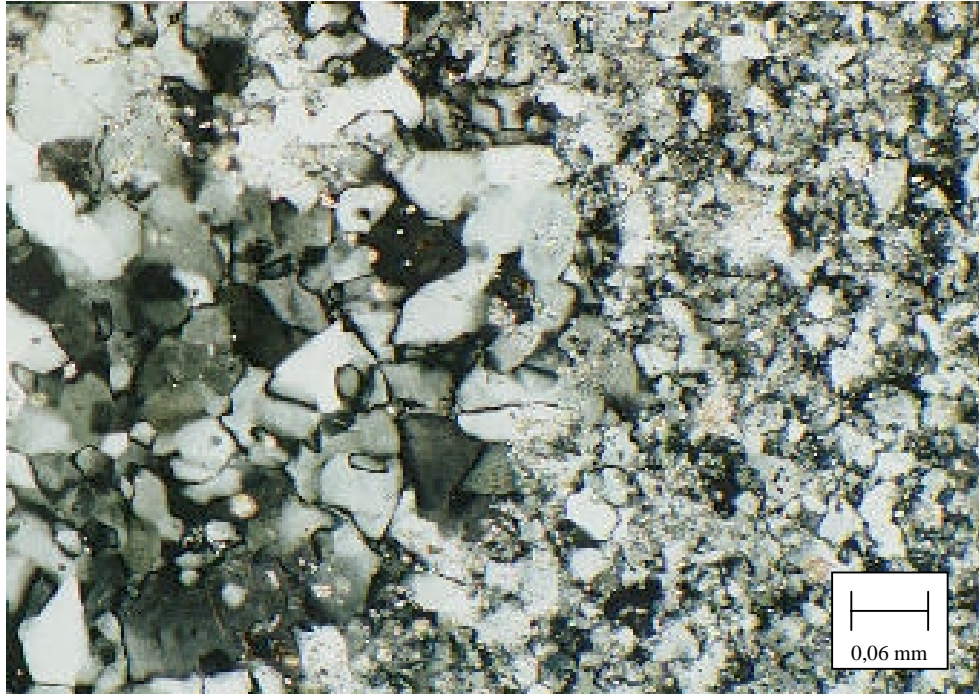
Abbildung 5: Polarisationsmikroskopische Aufnahme (gekreuzte Polarisatoren) der Mörtelprobe D1 aus Dorste. Die Abbildung zeigt den Übergang von groben Gipskristallen (in Poren oder Grobkorn) zur feineren Gipsmatrix
