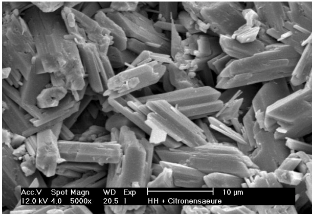
Abbildung 38 : Rasterelektronenmikroskopische Aufnahme einer erhärteten Gipspaste aus \beta -HH bei Zugabe von Citronensäure
