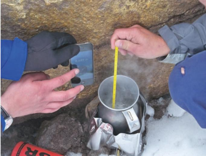
Abb. 5: Messung der Siedetemperatur des Wassers während der Exkursion in den Anden. Foto der Autoren.
