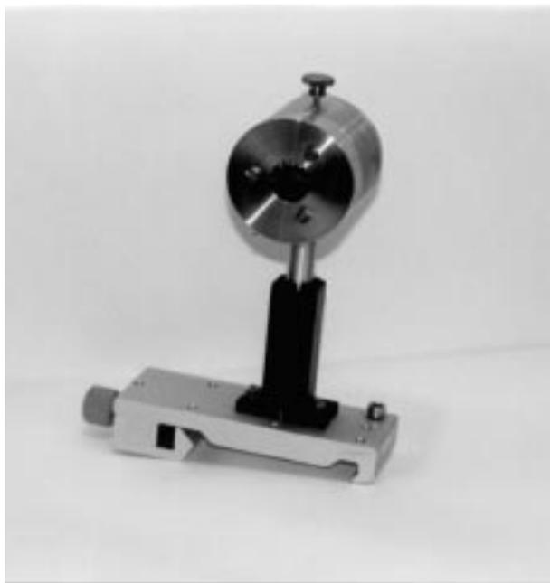
Abb. 16: Halterung des Polarisators mit Reiter für X95-Profil
