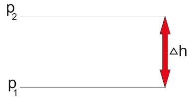
**Abbildung 6.4:** Druckdifferenz zwischen zwei Schichten unterschiedlicher Höhe.
