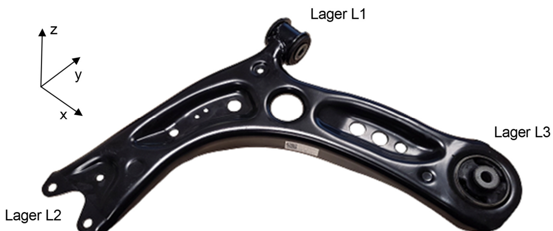
Abbildung 7-1: Original-Querlenker im Fahrzeug-Koordinatensystem (Fahrerseite)
