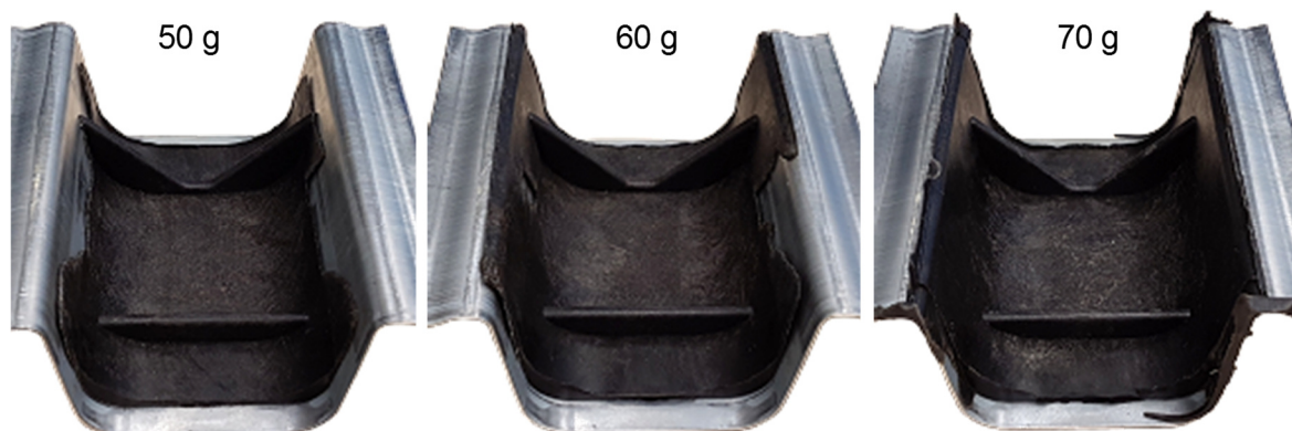
Abbildung 4-5: U-Profile der Stempelvariante V1-2 mit steigender LFT-Einlegemasse
