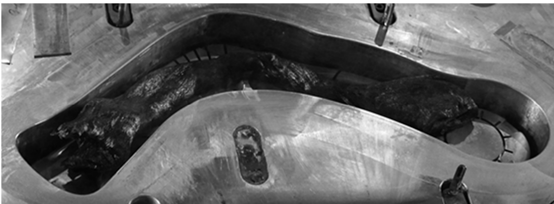
Abbildung 8-11: Einlegeposition von ca. 600 g LFT im Querlenker-Werkzeug
