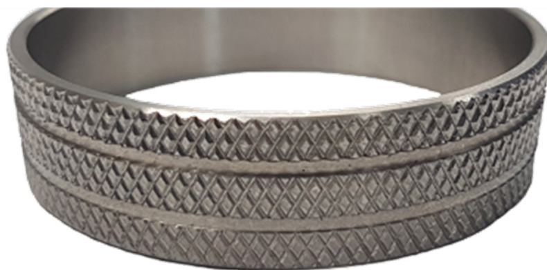
Abbildung 8-20: Stahlhülse mit Rändelung und radialen Nuten zum Warmeinbetten in LFT
