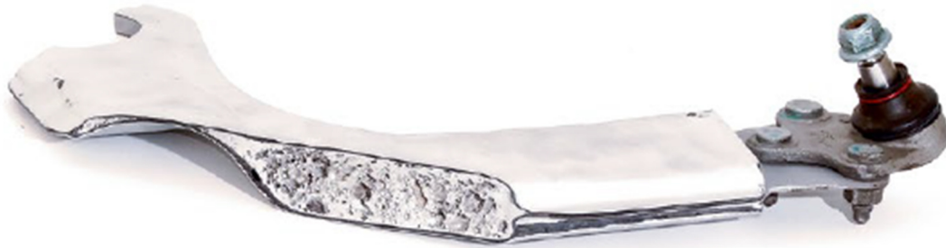
Abbildung 2-18: Sandwich-Querlenker mit Schaumkern aus Aluminium und Hybridlaminat [67]
