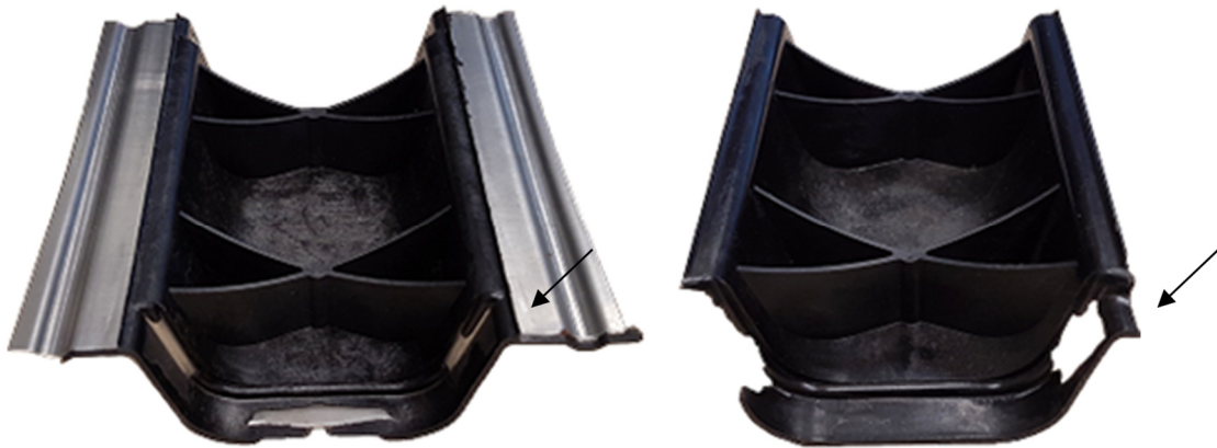
Abbildung 4-11: U-Profil der Stempelvariante V2-1 (li.) und LFT-Teil der Variante V2-2 (re.)
