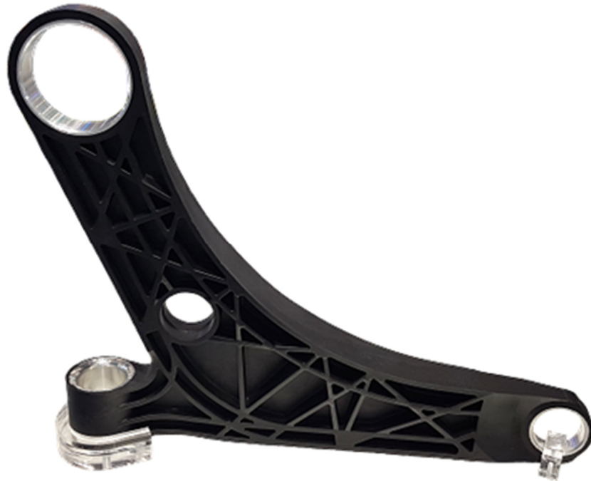
Abbildung 2-19: Hybrider Querlenker von PULINA und LIETAER [69] auf der JEC-Messe 2019
