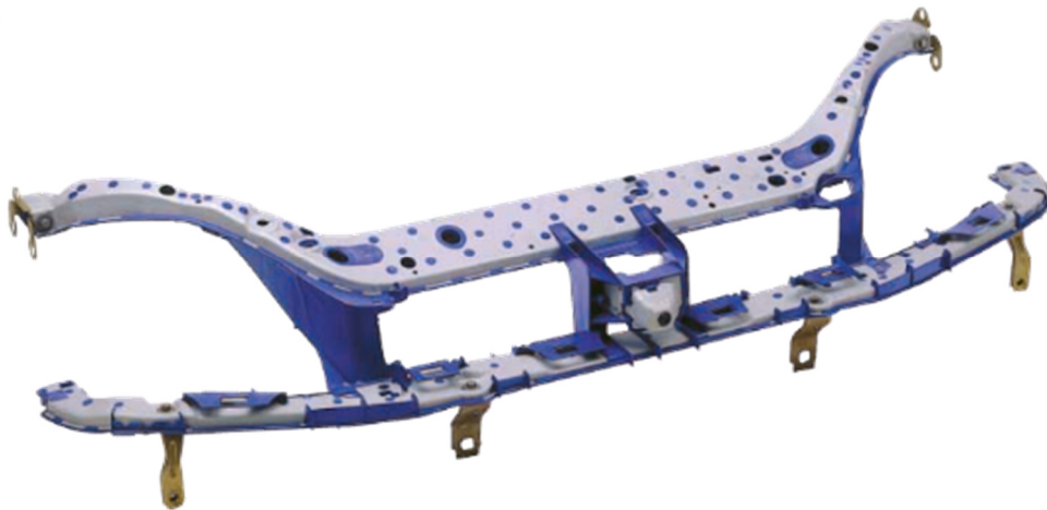
Abbildung 2-14: Hybrides Frontend des Ford Focus aus dem Jahr 1999 [48]
