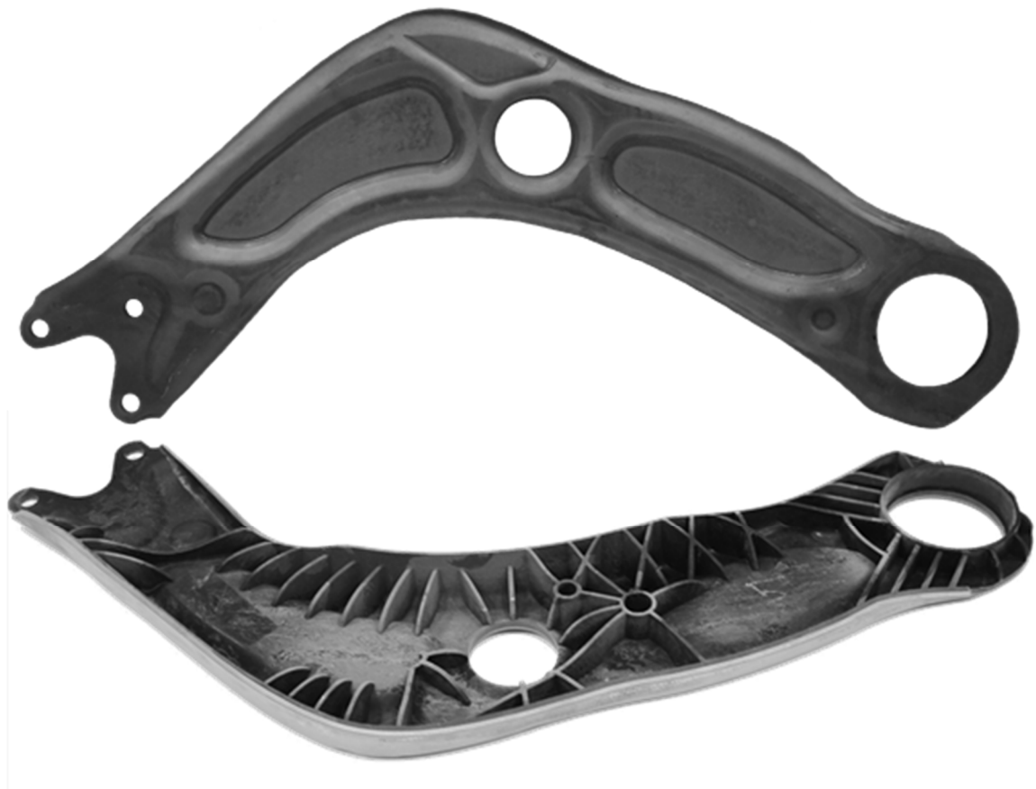
Abbildung 8-23: Querlenker nach dem 3D-Wasserstrahlschneiden
