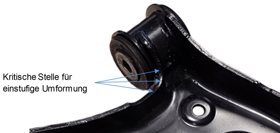
Abbildung 8-1: Bereich um das Lager L1 des Original-Querlenkers
