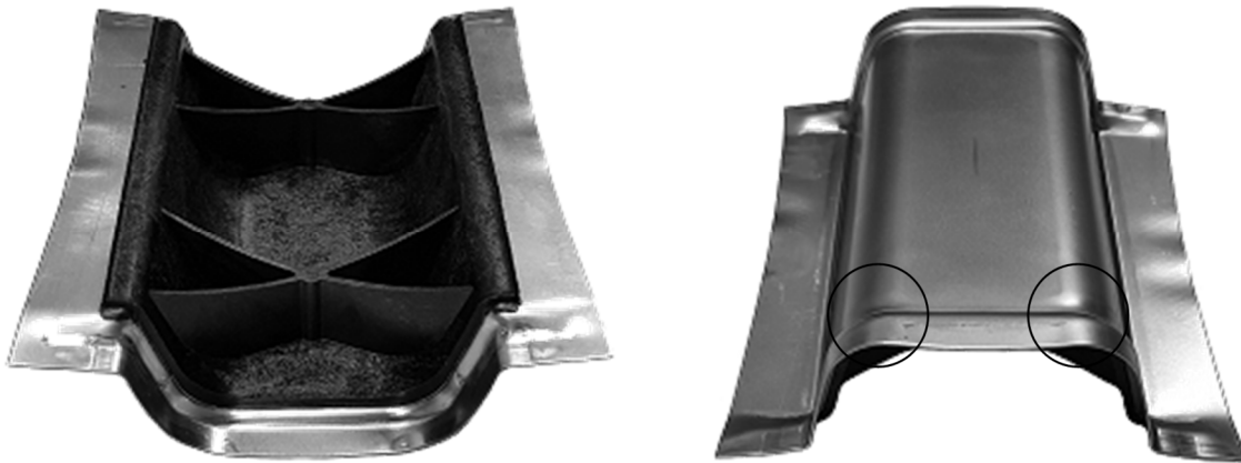
Abbildung 4-17: Vollständig geformtes U-Profil mit hoher Presskraft
