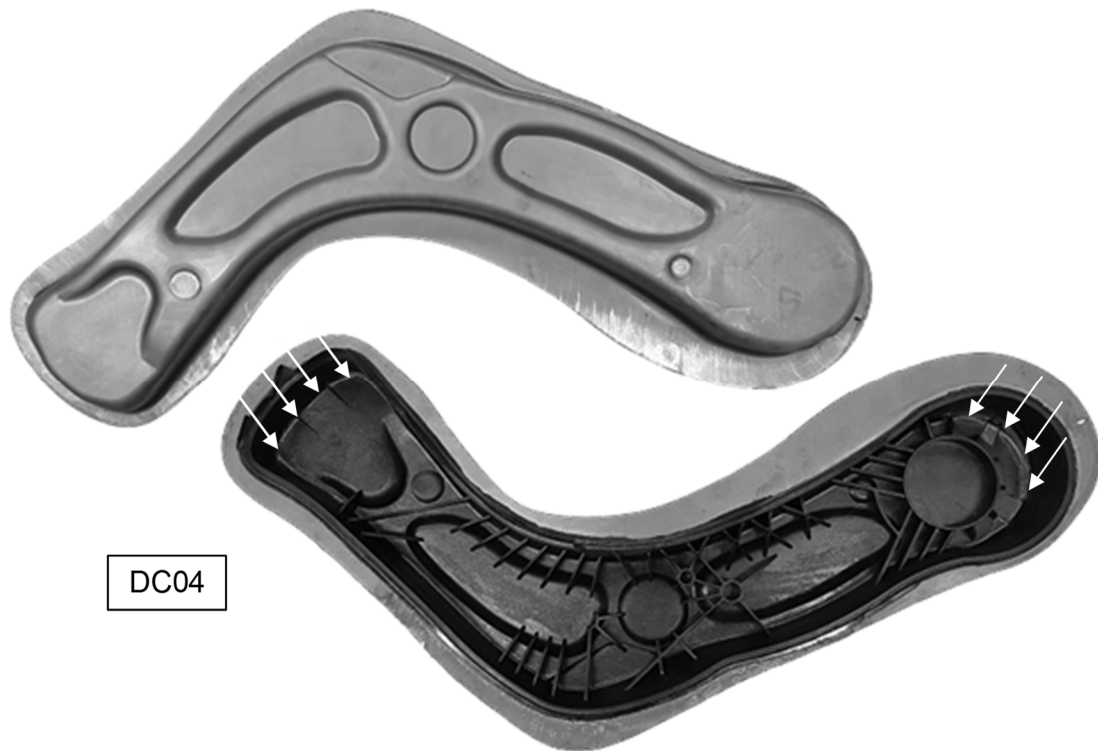
Abbildung 8-12: Hybridgepresster Querlenker aus DC04-Stahl (weiße Pfeile = sichtbarer Stahl)
