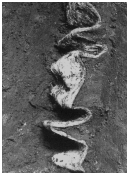
Abb. 3.2: l.: gekräuselter Vertikaldrän, r.: Zusammenhang zwischen Seitendruck und Durchflusskapazität (aus DIN EN 15237:2007 [22]).
