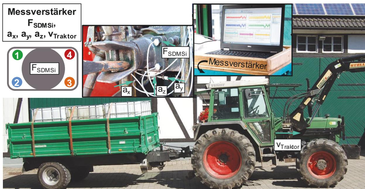
**Abbildung 92:** Versuchsaufbau „Befestigungverschraubung einer Traktoranhängerkupplung“
