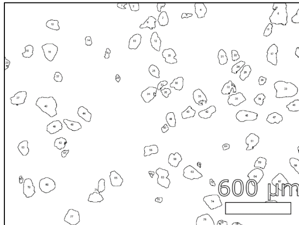
Abbildung 4.4: Auswertung der REM Aufnahme aus Abbildung 5.3 mit ImageJ
