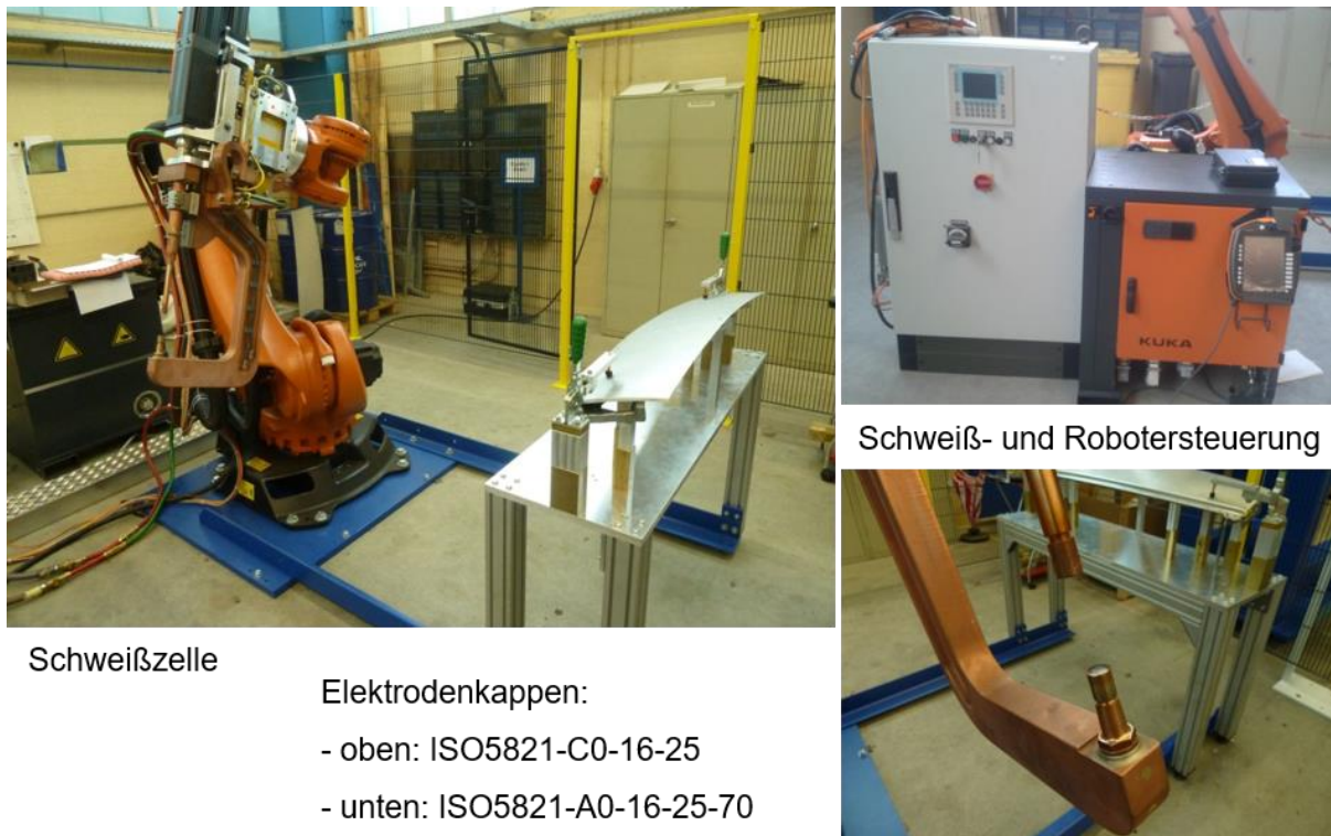
Abbildung 5-14 Aufbau der Schweißzelle für die Versuche (Fa. Dalex)
