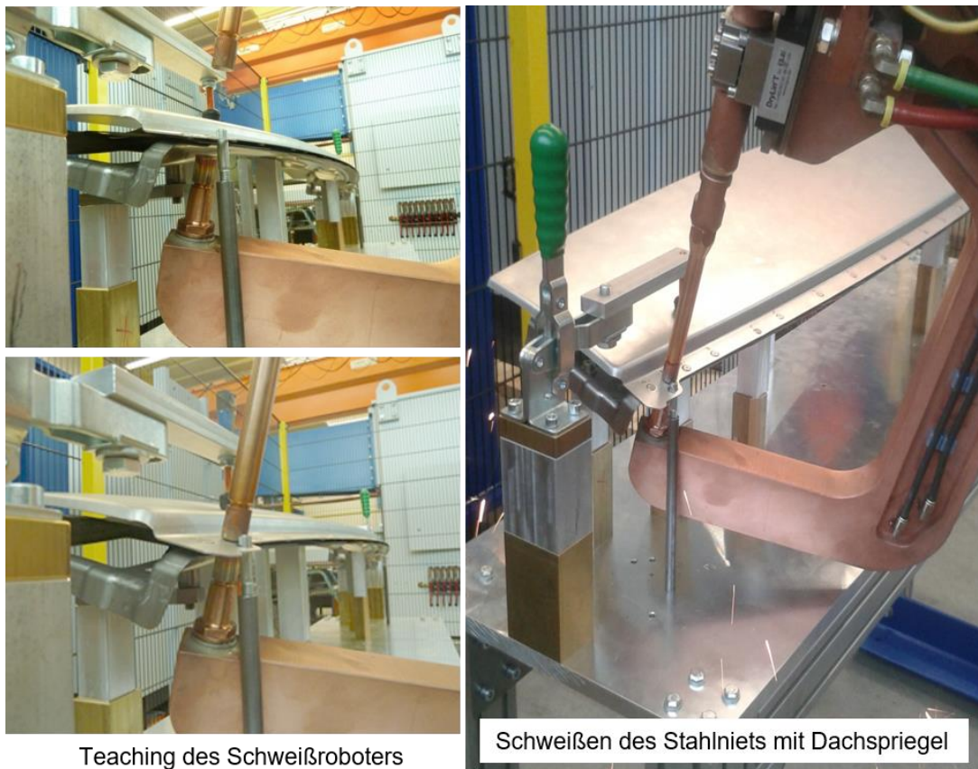
Abbildung 5-16 Teaching des Schweißroboter und Schweißen des Al-Teildachs mit Dachspriegel (Fa. Dalex)
