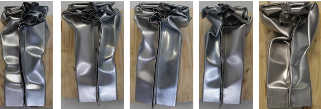
Abbildung 9-39 unterschiedliche Deformationen der Versuchsproben bei axialen Crash mit Fallturm
