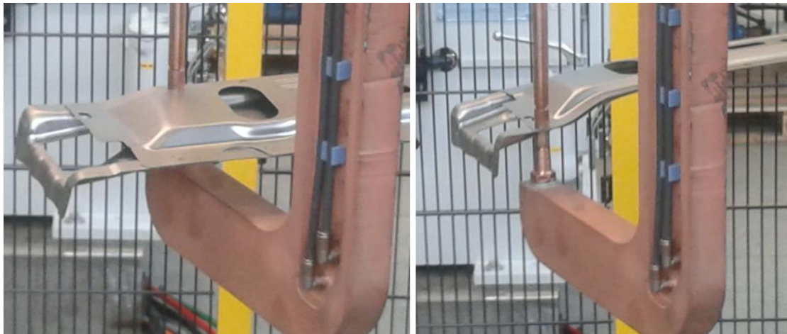
Abbildung 5-15 Zusammenschweißen des Stahl-Dachspriegels
