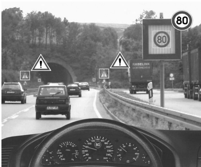
Abbildung 3.4: Verkehrszeichenerkennung mit einer Videokamera
