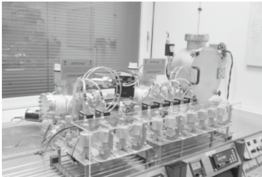
Abb. 9.3.1: Prozeßgassteuerung der Bandanlage
