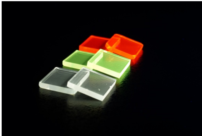
Abbildung 4.15: Mit den SE Tb^{3+} -, Eu^{3+} - und Dy^{3+} -dotierte LiB- (links) und LiAlB-Gläser (rechts) unter UV-Anregung mit einem NW-zu-NB-Verhältnis von 1 : 6.
