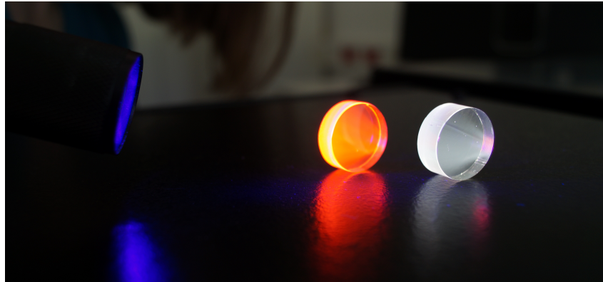
Abbildung 1.1: Lithium-Aluminium-Boratgläser: optisch aktiviert mit den Seltenen Erden Europium (rötlich) und Dysprosium (weißlich). Das Leuchtstoffsystem wird mit einer ultra-violetten Lampe angeregt.
