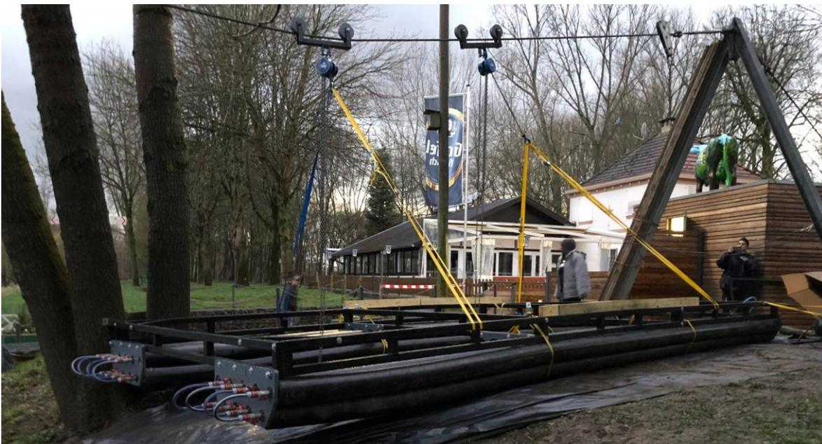
Abbildung A-9: Floß in Katamaranbauweise zur Untersuchung der Prototyp in der Sieg
