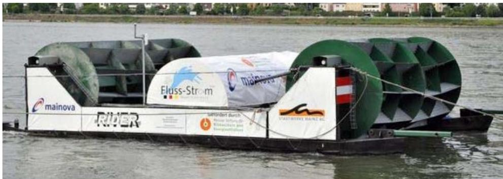
Abbildung 4-16: River Rider Tandem (Fluss-Strom, 2019)
