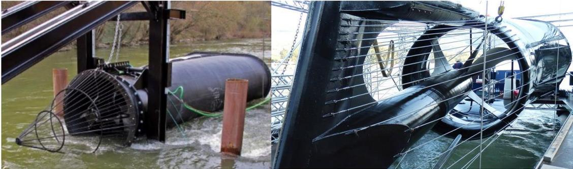
Abbildung 4-15: KSB-Flussturbine (links; Fa. KSB), Strom-Boje 3 (rechts; Aqua Libre, 2019)
