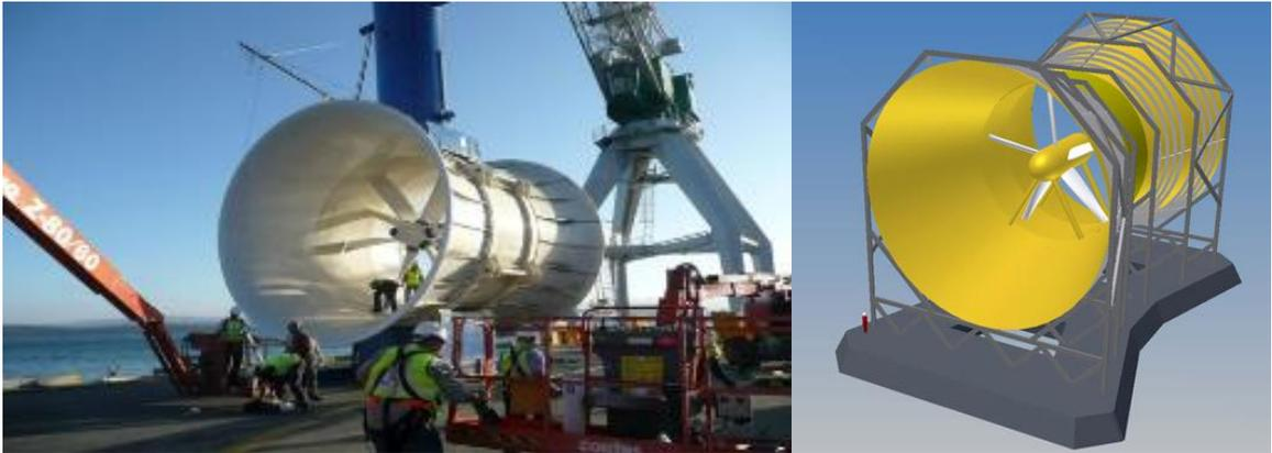
Abbildung 4-11: Solon Tidal Turbine - AS-Serie (links; Atlantis Resources Corporation, 2011), 3D-Modell der Rotech Tidal Turbine (rechts; Lunar Energy Ltd., 2011)
