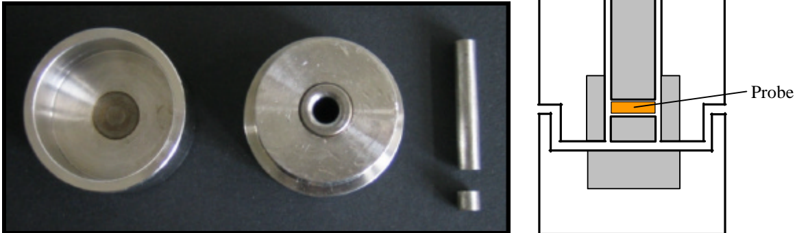
Abbildung A.14: Vierteliges Preßwerkzeug mit einem Inlet aus oberflächlich gehärteten Stahl (grau).
