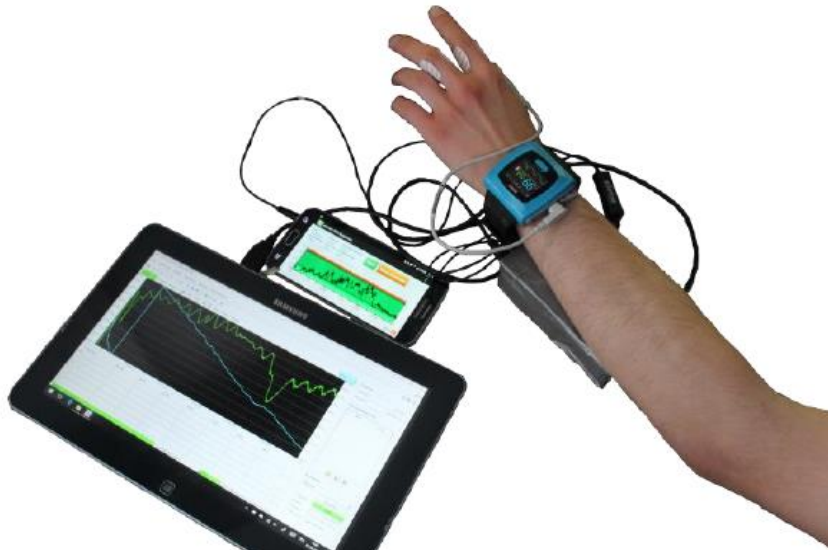
Abbildung 6-1: Technisches Equipment während der Datenaufnahme. Der linke Unterarm liegt mit seinem Eigengewicht auf dem EM-Sensor, welcher über den miniVNA und das gezeigte Tablet kontinuierlich die Streuparameter detektiert. Die Armbanduhr detektiert mittels eines Fingerclips den Puls und die Sauerstoffsättigung des Teilnehmers. Das Smartphone dient der Datenerhebung des Hautleitwertes. Die Elektroden des verwendeten eSense-Gerätes sind an den Fingergliedern des linken Zeige- und Mittelfingers befestigt. [106]
