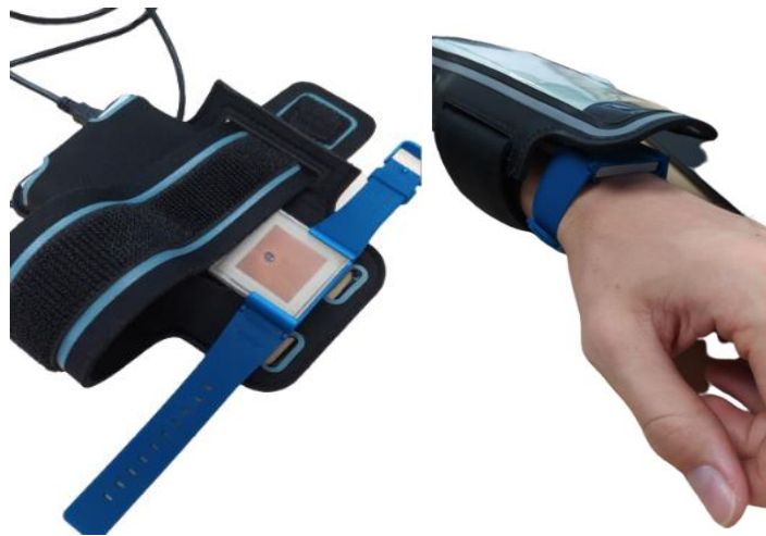
Abbildung 7-3: Messsonde zur Detektion von Frequenz, Return Loss und Phase während der Validierung
