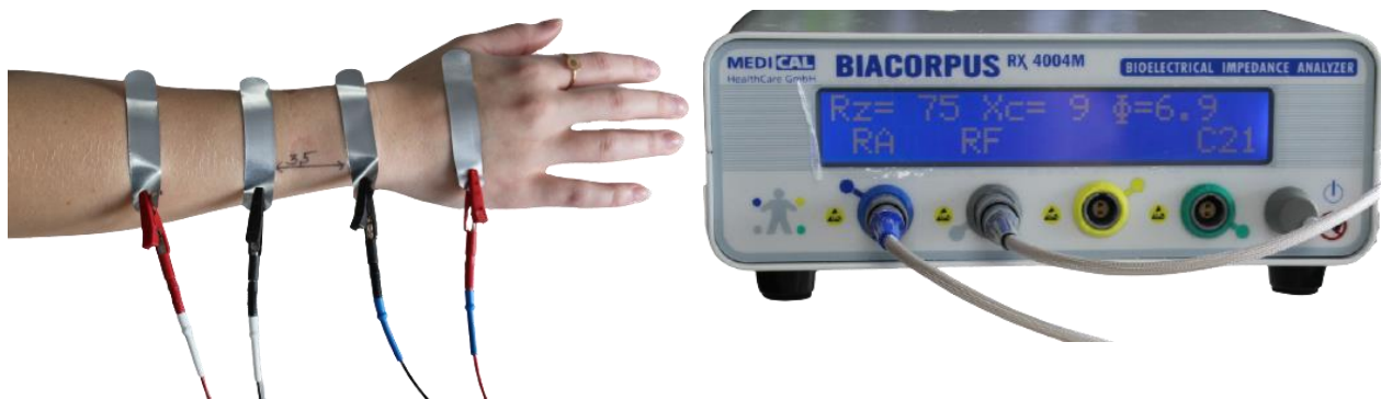
Abbildung 7-5: Links: Messelektroden für die Datenaufnahme der Bioimpedanz werden an der rechten Hand angebracht. Durch das rote Kabel wird Strom in die Haut induziert. Über die schwarzen Kabel wird die Bioimpedanz gemessen. Der Abstand zwischen den Messelektroden beträgt 3,5 cm. Der Abstand zwischen den roten und schwarzen Elektroden beträgt 4 cm. Rechts: BIACORPUS RX 4004 M Messgerät (MEDICAL healthcare GmbH, Deutschland) mit der Angabe von Reaktanz, Resistanz und Phase. Da nur an einem Körpersegment gemessen wird, werden ausschließlich zwei der vier Buchsen benötigt.
