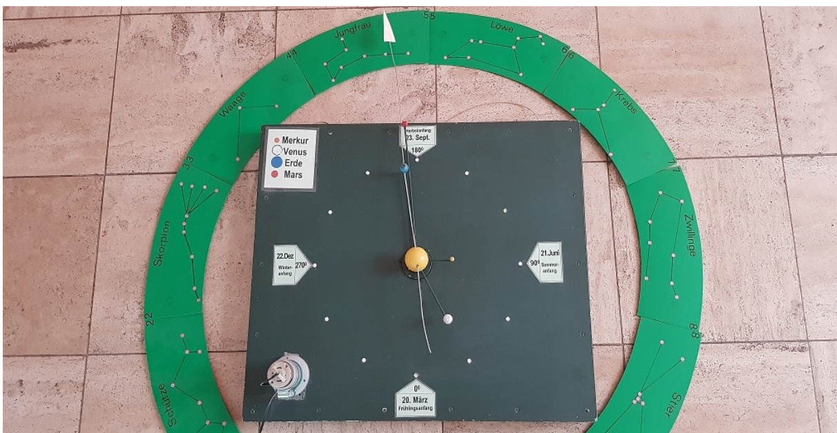
Abbildung 69: Selbstbaumodell zur Darstellung der Bewegung der Planeten gegenüber dem Sternhimmel
