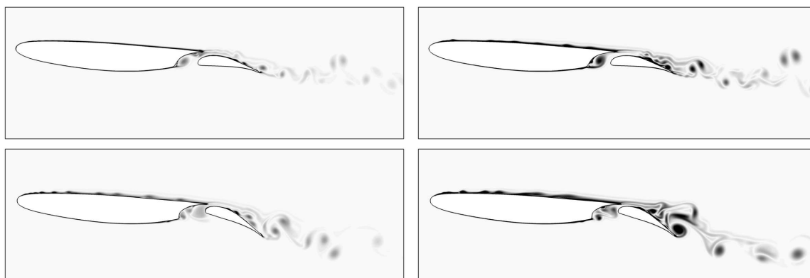
Abb. 4.3: Instantane Visualisierung der Wirbelstärkemagnitude |\omega_z| : 2-D Konfiguration Wing \delta 8 (oben) und Wing \delta 22 (unten), jeweils mit M_\infty = 0.175 (links) und M_\infty = 0.4 (rechts). Die Farbskala reicht von 0 (weiß) bis 60U_{\text{ref}}/D_s (schwarz).
