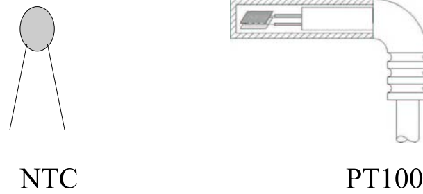
Bild 4.4: Schematische Darstellung des NTC- und des PT100-Sensors
