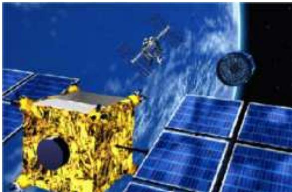
**Abbildung 11:** Schematische Darstellung der Satellitenmission XEUS. Die Spiegeloptik und der Röntgendetektor befinden sich auf zwei verschiedenen Satelliten mit ca. 50 m Abstand voneinander. Die relative Ausrichtung der beiden Module relativ zueinander ist dabei auf  $1 \text{ mm}^3$  genau.
