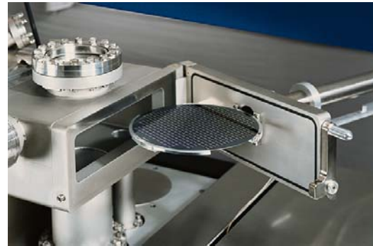
Abb. 8.1: ION-TOF IV der Firma ION-TOF in Münster (links) mit einer Nahaufnahme der Schleusenkommer mit einem 200 mm-Wafer (Quelle: Materiallabor IBM Mainz).
