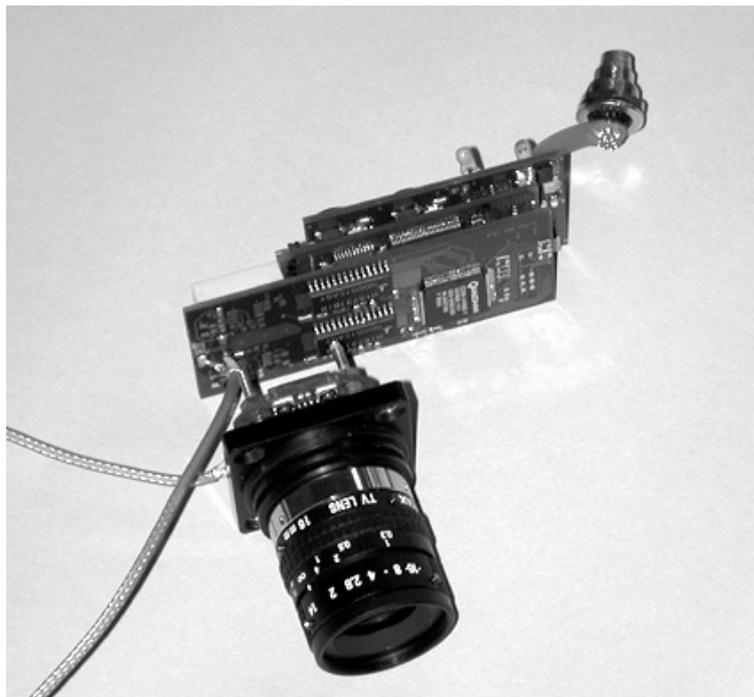
**Abb. 5.27:** Hardware des realisierten Demonstrators eines chirpbasierten Übertragungsverfahrens mittels PMD a) Emitter b) Receiver, jeweils mit Chirp-Generator zur Modulation bzw. Demodulation
