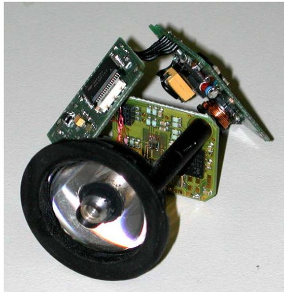
**Abb. 4.29:** Technologiedemonstrator eines PMD-basierten eindimensionalen Laserentfernungsmessgerätes für den industriellen Einsatz
