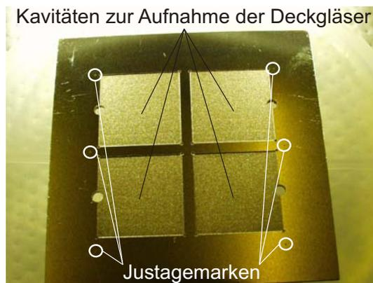
**Abb. 3.5:** Belichtungshalterung aus Edelstahl mit Kavitäten zur Aufnahme der Deckglassubstrate und Justagemarken.
