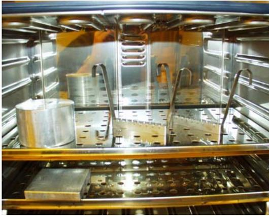
**Abb. 3.14:** Halterung aus Edelstahl zur vertikalen Aufnahme der Deckglassubstrate für den Transport und die Lagerung.
