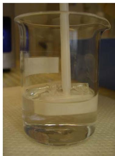
**Abb. 3.13:** Detailphotographie der Halterung aus Teflon zur gleichzeitigen nasschemischen Strukturierung von 8 Deckglassubstraten.
