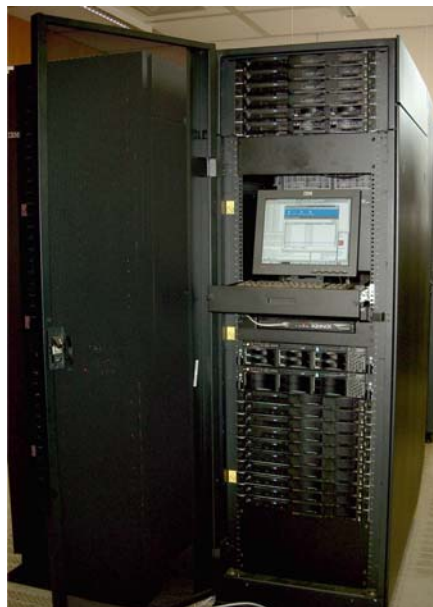
Abbildung 10.8: Rubenscluster der Universität Siegen mit 296 AMD-Opteron-Prozessoren
