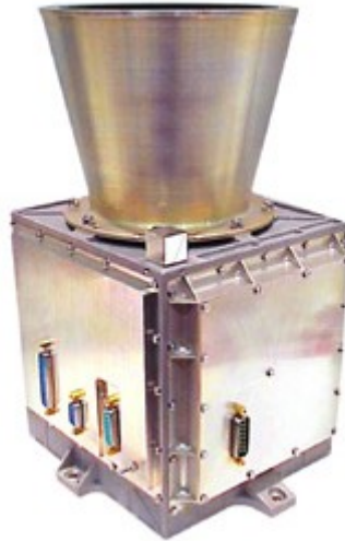
Abbildung 8.5: Star Tracker zur Lagemessung eines Satelliten im Raum. Quelle: Finmeccanica [FINMECCANICA 2008].
