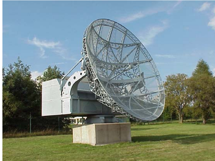
Abbildung 1.2: Radargerät „Würzburg-Riese“ (Funkmeßgerät FuG 65). Es war wichtiger Bestandteil der deutschen Luftverteidigung im zweiten Weltkrieg. Nach dem Krieg wurden einige der Würzburg-Riesen zu Radioteleskopen umgebaut und lange zur Erforschung der Ausdehnung des Weltalls eingesetzt. Quelle: Wikipedia
