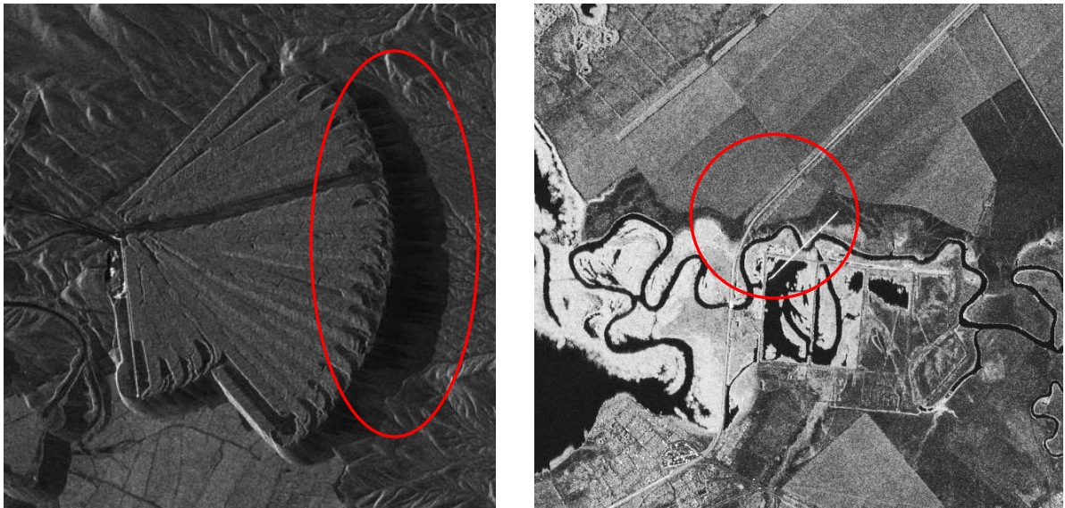
Abbildung 2.14: Links: Beispiel für Shadowing: Im rechten Teil des Bildes (rot eingekreist) erkennt man im prozessierten Bild einen deutlichen Schatten einer Abraumhalde, in dem gar keine bzw. nur sehr schwache Radarechos aufgenommen worden sind. Quelle: DLR.
