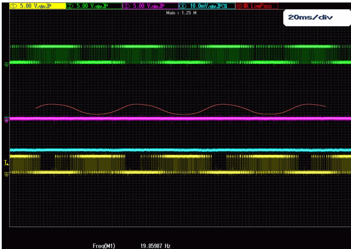
Abb. 8.2.10: Ansteuersignale der bidirektionalen Schalter S1 und S2 mit dem geglätteten Signal von S2
