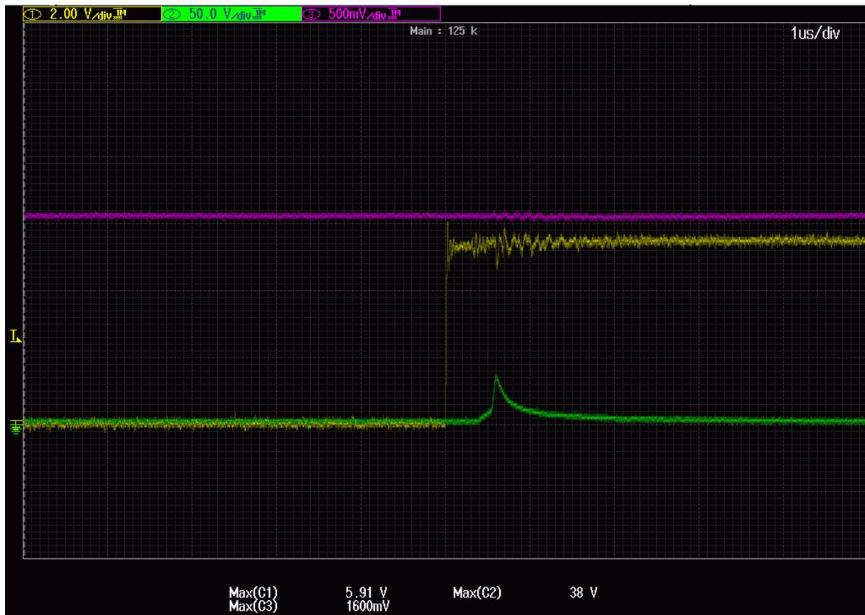
Abb. 5.3.4: Ergebnis der Schalthandlung mit unterschiedlichen Gatewiderständen
