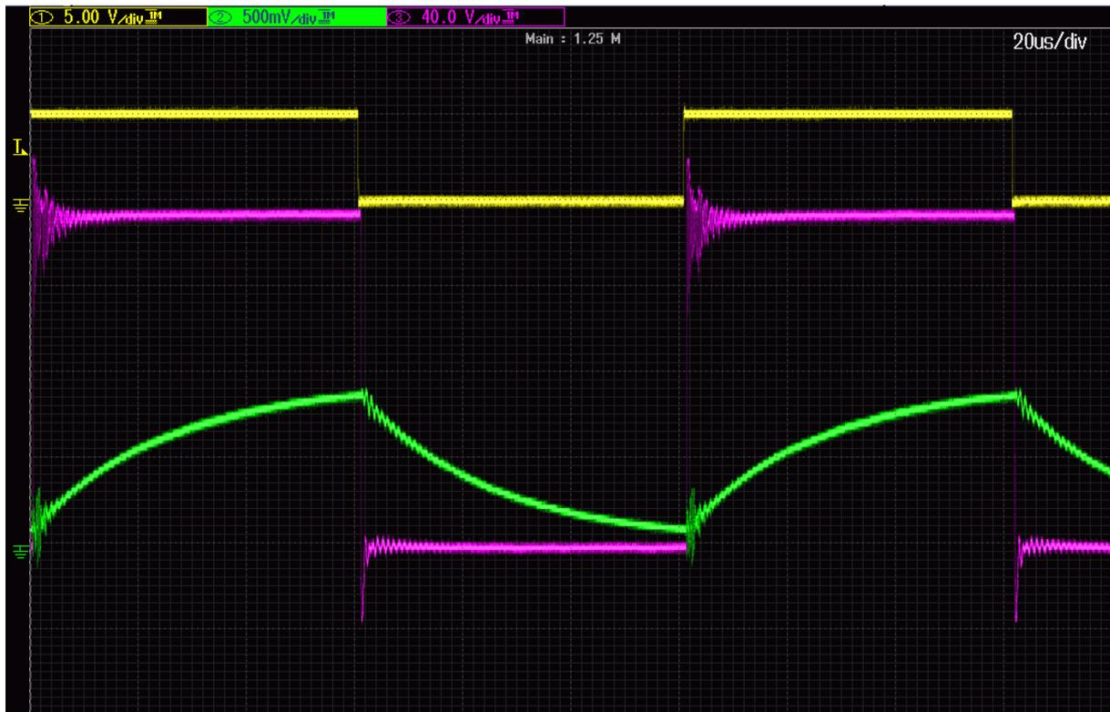
Abb. 5.3.2: Ergebnis der Testschaltung des schaltbaren Freilaufkreises
