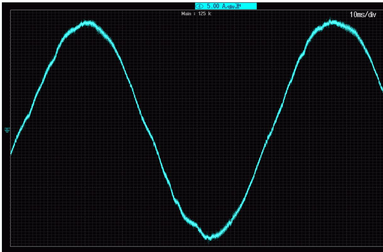
Abb. 8.1.5: Unterbrechungsfreier Ausgangsstrom des Matrixumrichters
