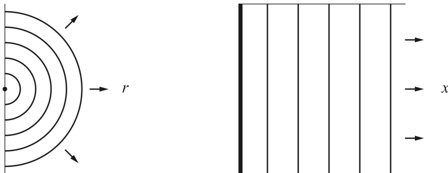
Bild 2.1: Kugel- bzw. Kreiswelle (links) und ebene Welle (rechts)
