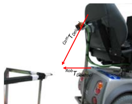
Abbildung 5.9.1: Versuchsaufbau zum fahrerlosen Andocken
