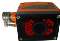
Abbildung 4.4.2: O3D-100 mit einer Auflösung von 64x50 Pixeln
