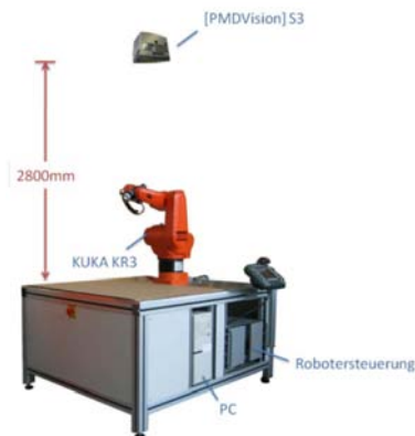
Abbildung 6.1.2: Versuchsaufbau der Roboterzelle
