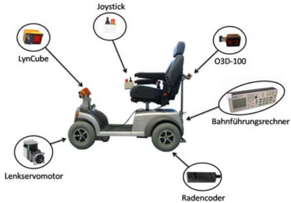
Abbildung 5.1.2: Sensorik der mobilen Roboterplattform
