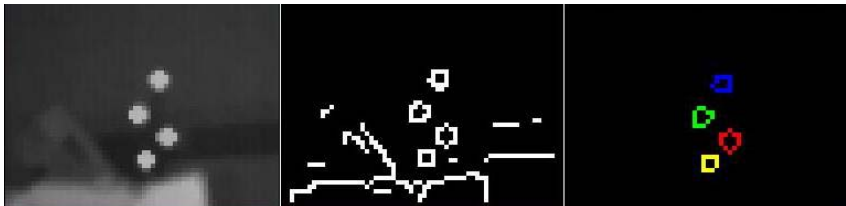
Abbildung 6.2.4: Algorithmenabfolge zur Erkennung des Referenzobjekts
