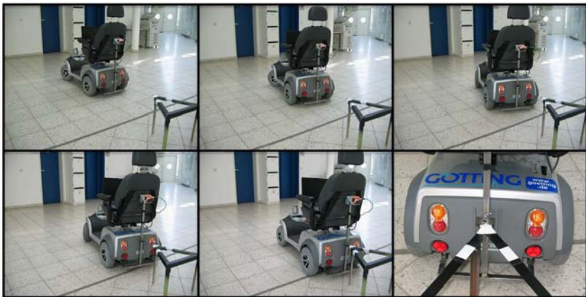
Abbildung 5.9.14: Andocken an ein Deichselmodell
