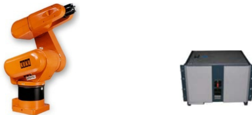
Abbildung 6.1.1: Kuka KR3 mit Schaltschrank
