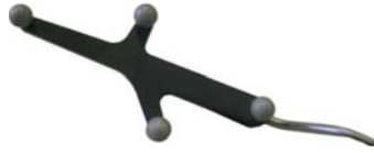
Abbildung 6.2.3: Kalibrierkörper für die Roboter-Kamera Kalibrierung
