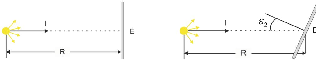
**Abbildung 3.7:** Veranschaulichung der Beleuchtungsstärke bei senkrechtem (links) und schrägem (rechts) Lichteinfall
