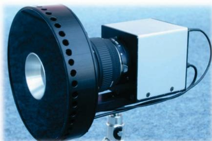
**Abbildung 3.16:** Ringförmige Beleuchtung der PMD Kamera einer 2D/3D MultiCam (links) und das dazugehörige Simulationsmodell (rechts)
