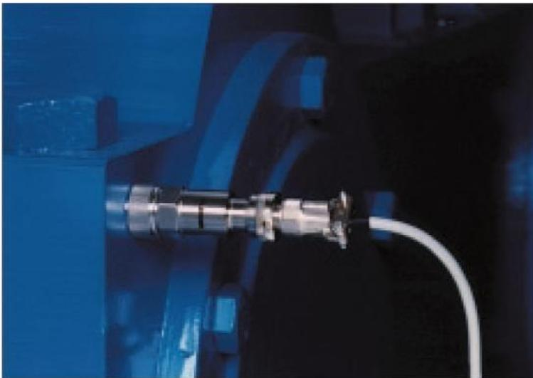
Bild 2.11: Beschleunigungssensor für die Schwingungsanalyse [44]
