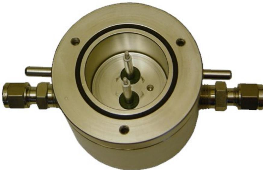
Bild 4.9: Sensorträger mit Glasdurchführung
