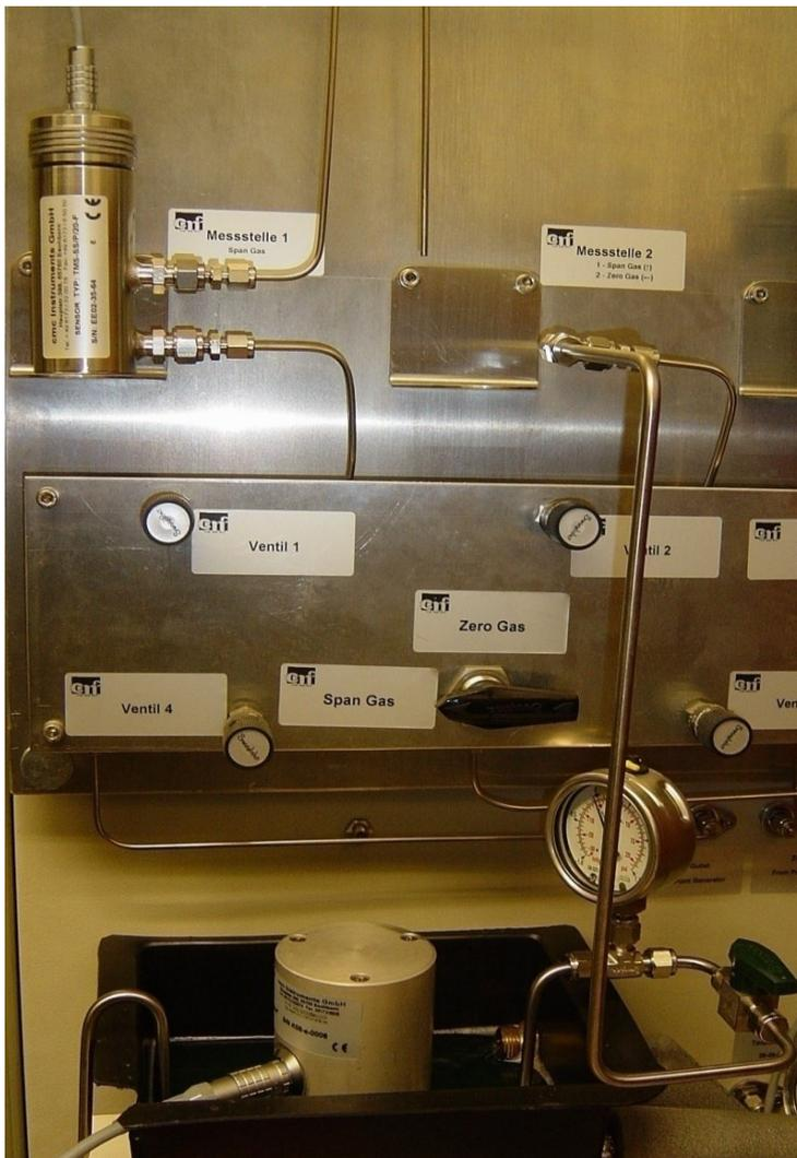
Bild 5.5: Foto des Prüfstands zur Gasfeuchtemessung
