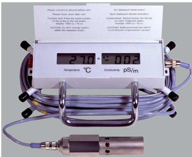
Bild 2.17: Leitfähigkeitsmessgerät MLA 900 [49]
