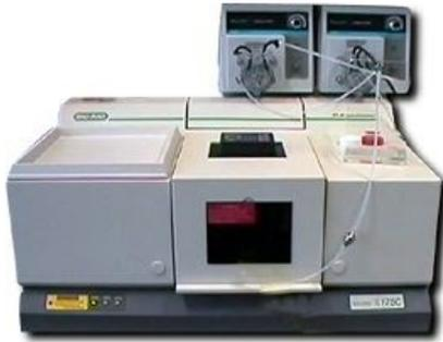
Bild 2.3: FT-IR-Gerät zur Untersuchung der Ölqualität [29]
