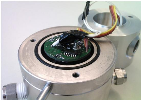
Bild 4.6: Integration im Sensorgehäuse [62]
