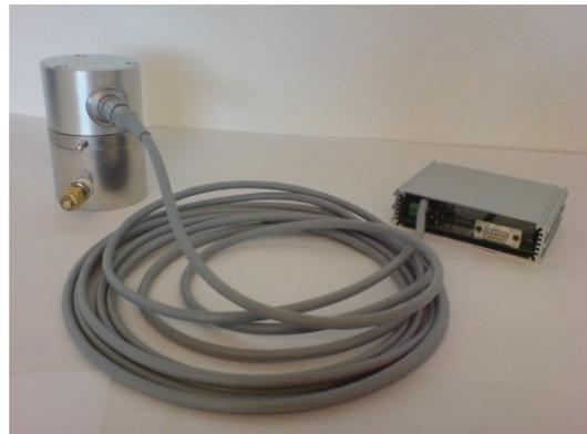
Bild 4.7: Gesamtdarstellung des Sensorsystems [62]
