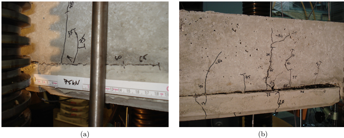
Abbildung 4.15: Prüfkörper B5 , (a) Rissbild im Stoßbereich bei 75 kN (30 kNm), (b) Rissbild im Versagenszustand
