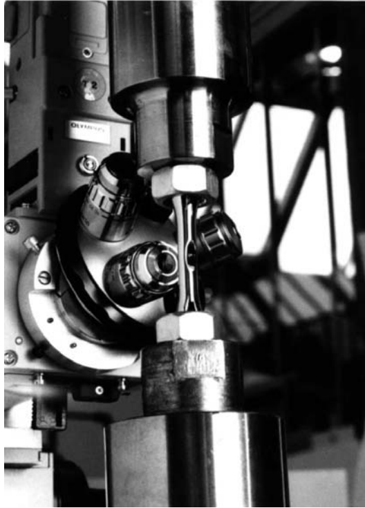
Bild 3.12: Lichtmikroskop zur "in-situ"-Beobachtung der Ausbreitung von Ermüdungsrissen.
