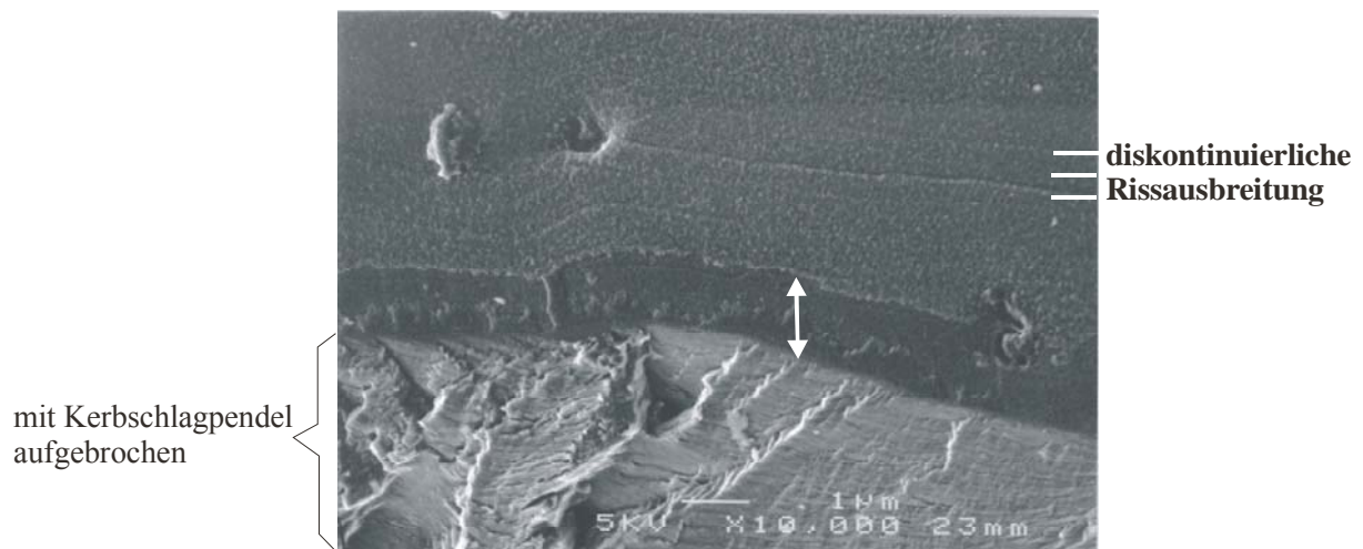
Bild 6.46: Interkristalline Risspitze eines unterbrochenen Vierpunktbiegeversuchs (IN718, T=650^\circ\text{C} ) mit Rissausbreitungstreifen (aus [399]).
