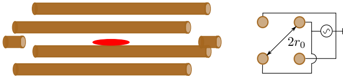
Abbildung 3.2.: Prinzipieller Aufbau einer linearen Paul-Falle. Die jeweils gegenüberliegenden Stäbe sind miteinander verbunden. Ein Paar der Stäbe wird auf einem konstanten Niveau gehalten, das andere Paar mit einer Wechselspannung (Amplitude V , Frequenz \Omega_{RF} ) getrieben. Die beiden Endkappen liegen auf einem positiven Niveau ( U ) und verhindern das Entweichen der in rot angedeuteten Ionenwolke. 2r_0 ist der Elektrodenabstand bei hyperbolischen Oberflächen. Bei einer anderen Geometrie der Elektroden muss r_0 noch mittels numerischer Simulation angepasst werden.
